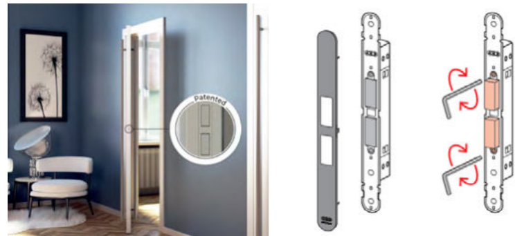
Az ajtót rögzítő mágneses erő, és ezáltal a nyitáshoz szükséges kézmozdulat erőssége finoman állítható a mágnes kijebb vagy beljebb állításával.
